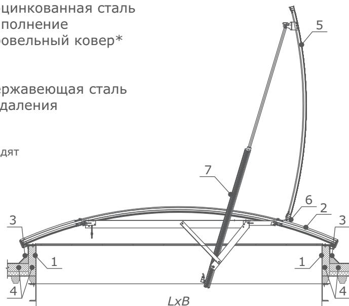
**Типовые характеристики люков в зенитных фонарях арочной формы**
