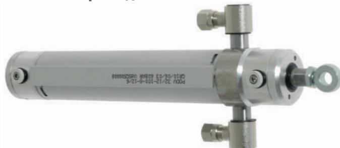
Пневмопривод предназначен для открывания створок люков с целью выполнения функции проветривания и/либо дымоудаления. Пневмопривод выполняется в корпусе из анодированного алюминия, поршень из нержавеющей стали с защитой от пылевого загрязнения, рекомендуемое рабочее давление: 0,6...1 МПа, максимальное постоянное рабочее давление: 6 МПа, блокировка при полном выдвижении — возможны другие варианты, максимальная осевая сила, передаваемая ригелем: 8000Н, возможность ручного освобождения блокировки.
